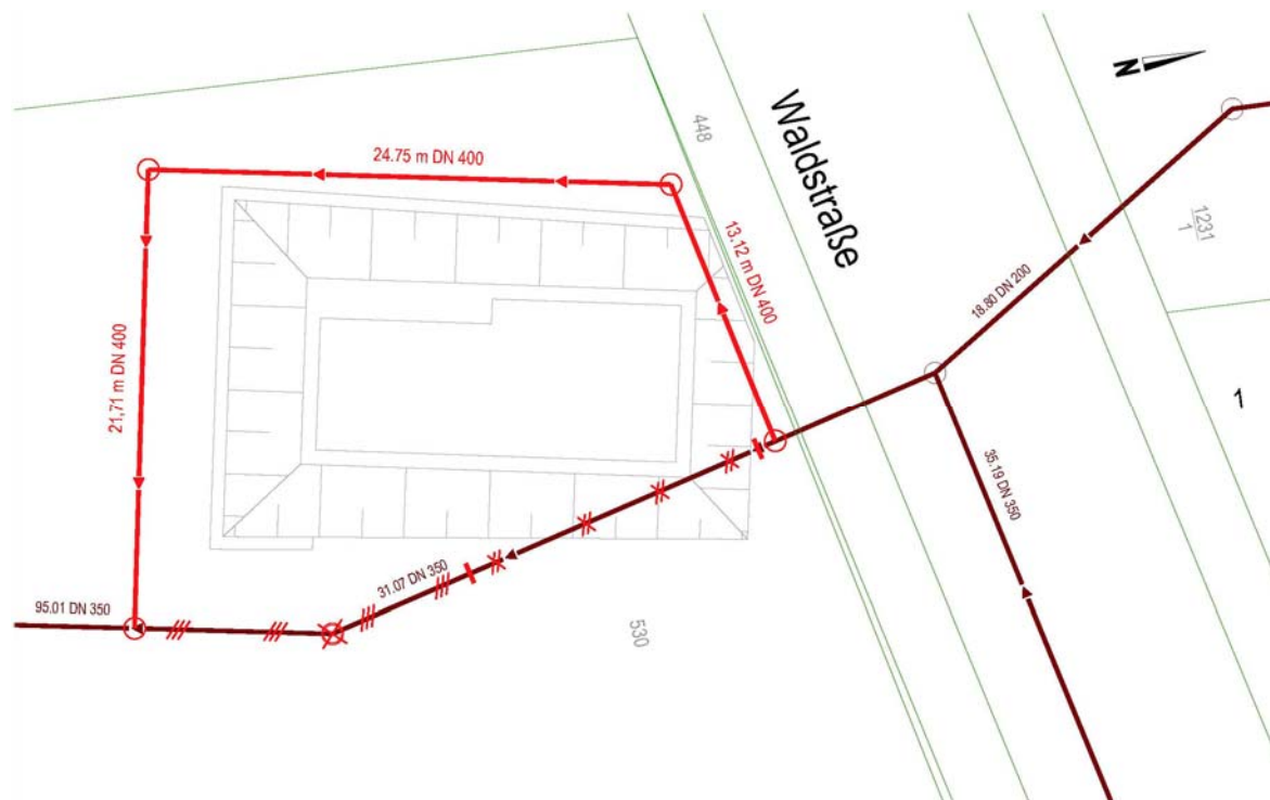
Abbildung 5: Provisorische SW-Kanalisation Hohen Neuendorf, Marie-Curie-Gymnasium
